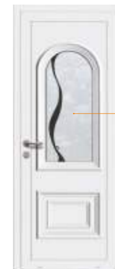
Fresnay Isolation thermique : Ud = 1.2W / (m 2 °C) Motif : identique intérieur/extérieur Panneau parclosé : PVC épaisseur 32 mm Disponible uniquement en blanc, beige et gris
