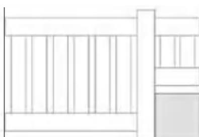
**Descriptif** : pose d'un poteau intermédiaire contre la boîte aux lettres. Pour une hauteur de clôture inférieure à 600 mm, la fabrication de l'élément du dessus devient délicate.
